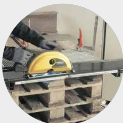
Idéale pour les caillebotis avec la lame de scie LBS résistant aux chocs Ideal for cutting metal grids with LBS impact resistant saw blade
